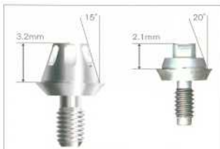
図11 従来のインプレッションポスト(左)と比べ、ユニバーサルインプレッションポスト(右)はテーパコーンタイプのため、印象時の歪みが生じにくい。
