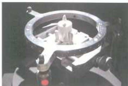
図2 ホワイトライトを使用した歯科用に特化したスキャナーで精度評価の誤差は2 \mu m以下である。
