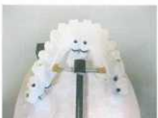
図③-06: レジンパターンで作製したチタンフレームの原型をラボサイドからDTIに送り、Delcam社製スキャナー「Metric」でスキャンする。レジンパターンが白く見えるのは、反射防止スプレーを塗布した状態のため。スターゲイトシステムで精密に作製されたチタンフレーム (右)。
