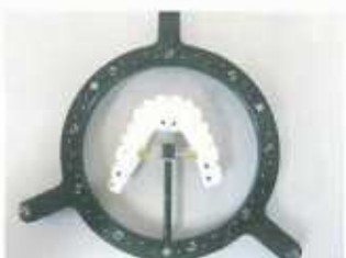
図③-06: レジンパターンで作製したチタンフレームの原型をラボサイドからDTIに送り、Delcam社製スキャナー「Metric」でスキャンする。レジンパターンが白く見えるのは、反射防止スプレーを塗布した状態のため。スターゲイトシステムで精密に作製されたチタンフレーム (右)。
