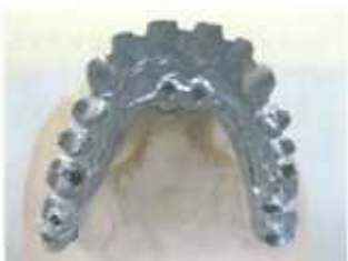
図③-06: レジンパターンで作製したチタンフレームの原型をラボサイドからDTIに送り、Delcam社製スキャナー「Metric」でスキャンする。レジンパターンが白く見えるのは、反射防止スプレーを塗布した状態のため。スターゲイトシステムで精密に作製されたチタンフレーム (右)。
